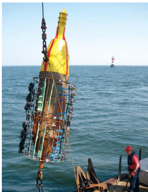
Ilustrācija 15 Testa boja ar dažādiem materiāliem, kur piestiprināties akvakultūras organismiem Roter Sand bākas apkārtnē [6]
