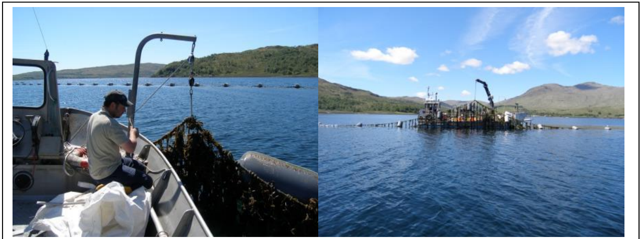
Ilustrācija 176 Dažādos audzēšanas posmos tiek izmantotas divu veidu laivas. Kreisajā pusē redzama mazā laiva ar mazu pacelājs, ko izmanto apskates laikā. Labajā pusē redzama lielā laiva ar lielu celtni, ko galvenokārt izmanto ražas novākšanai un "zeķu" izvilksanai no ūdens.
