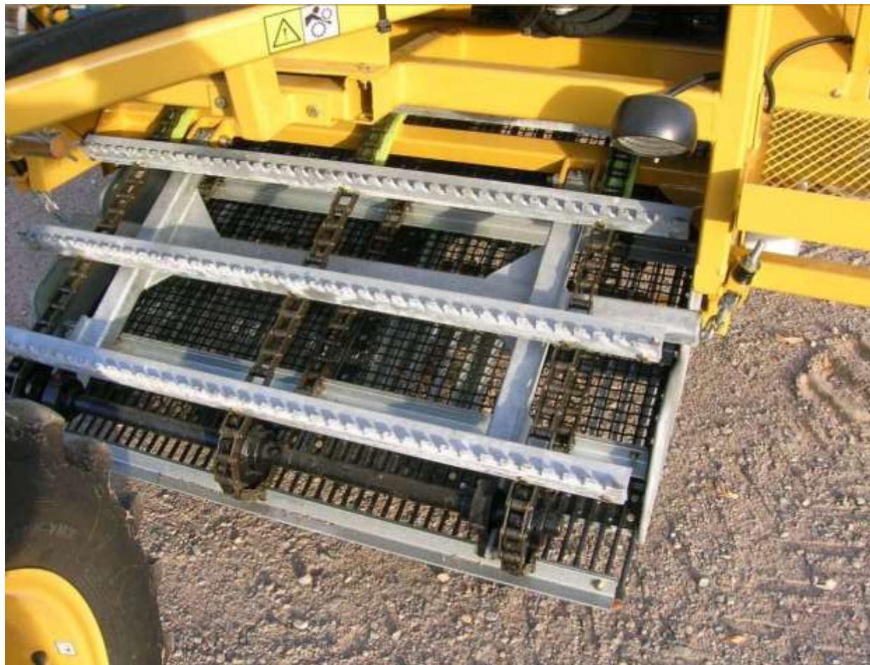
Ilustrācija 9. "Cherrington" firmas atkritumu savākšanas mašīnas savākšanas mehānisms. 13
