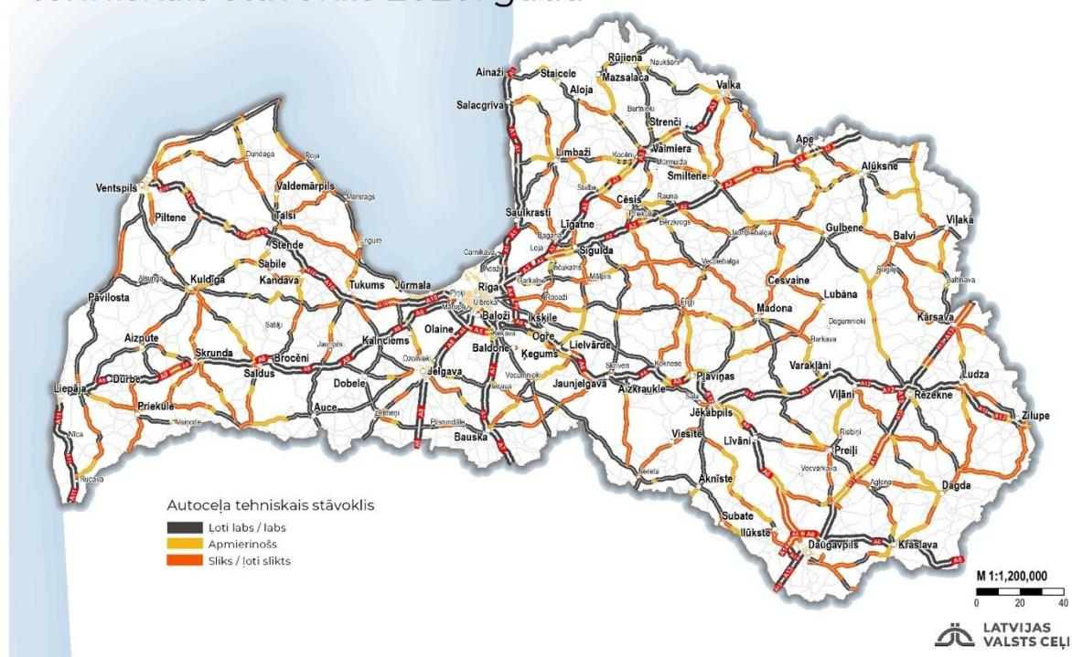
12.attēls. Ar asfaltbetonu klāto valsts reģionālo autoceļu stāvoklis pēc vizuālā novērtējuma 2020.gadā
