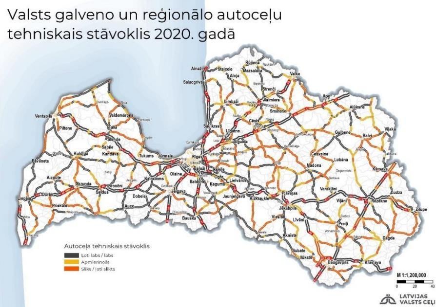
12.attēls. Ar asfaltbetonu klāto valsts reģionālo autoceļu stāvoklis pēc vizuālā novērtējuma 2020.gadā
